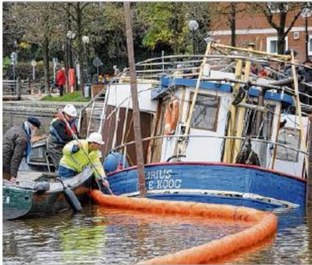
Sicherheitshalber wurden vor der Bergung Ölsperren ins Wasser gelegt.
